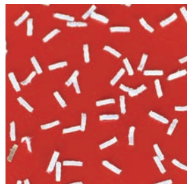
Cross-Cut 0,8 x 4,5 mm DIN Sicherheitsstufe 5 – entspricht Top Secret Anspruch
